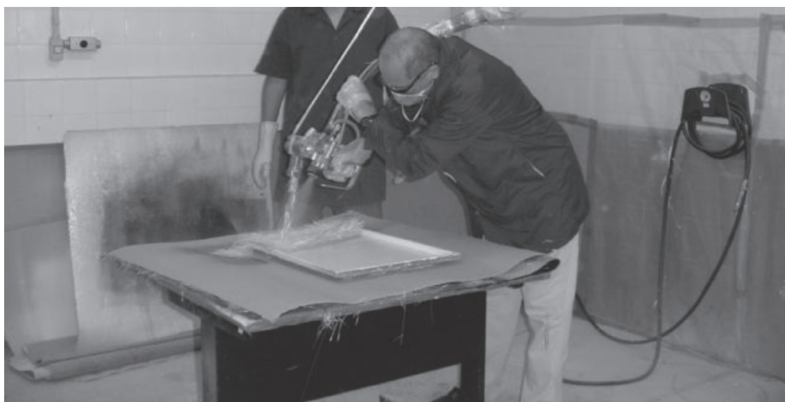
Figura 8.4 – Laminação por projeção ( spray-up ) em escala laboratorial (Cortesia: ABMACO)
