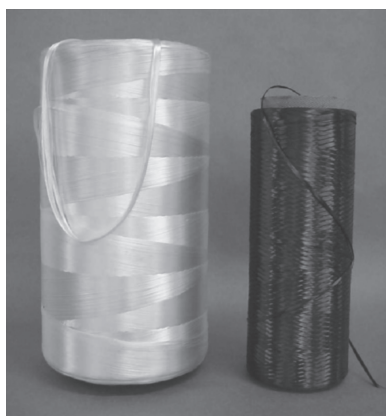
Figura 3.8 – Foto de uma bobina de PAN e de uma bobina de fibra de carbono
