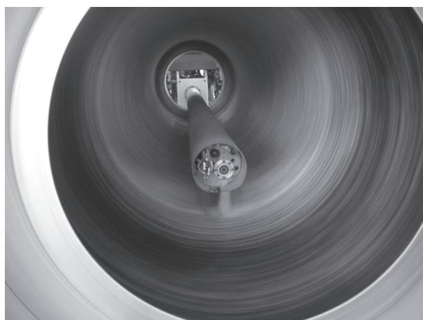
Figura. 8.28 – Sistema de alimentação das matérias-primas (Cortesia: Amitech)
