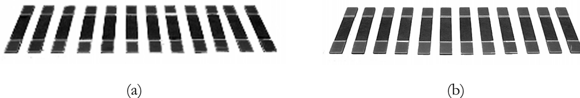
Figura 5.2.1– Corpos de prova usados nos ensaios de tração: a) laminado F155/8HS; e b) F584/8HS
