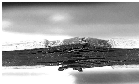
Figura 5.2.20 – Laminado F584/8HS após o ensaio de compressão, mostrando as zonas de dobramento ( kink zones ) e a fratura
