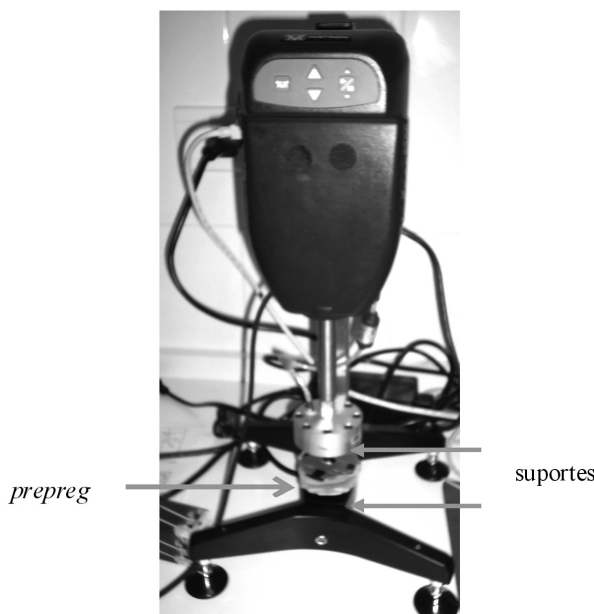
Figura 5.1.4 – Aparato experimental da marca Instron, modelo In-Spec 2002, usado para realizar os ensaios de tack
