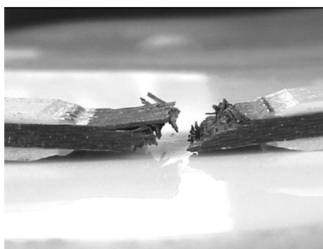
Figura 5.2.18 – Laminado F155/PW após o ensaio de compressão, mostrando o tipo de falha por cisalhamento
