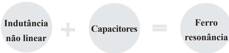
Figura 7.8 – Ocorrência da ferro-ressonância
