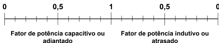
Figura 6.10 – Escala de fatores de potência atrasado e adiantado
