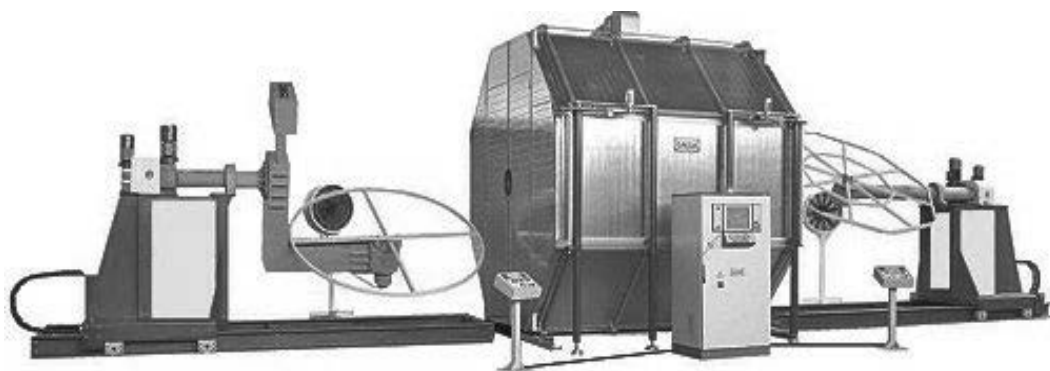
Figura 2.16 – Equipamento para rotomoldagem
