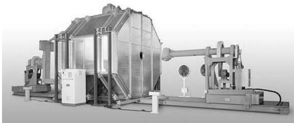
Figura 2.15 – Equipamento para rotomoldagem
