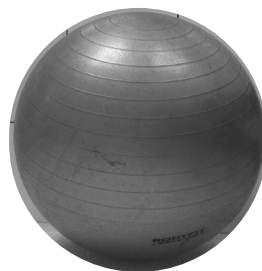
Figura 5.4 – Bola inflada de plastissol, com 80 cm de diâmetro.
